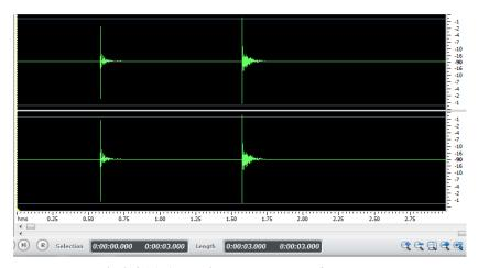
Fig 2.4 (d) Acoustic measurement of ball speed
