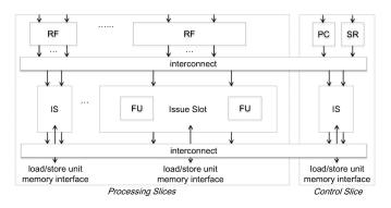
Fig. 1. Reference VLIW ASIP template
