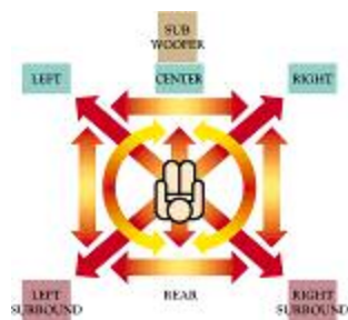
Figuur 3: Een opstelling van luidsprekers voor het optimaal beluisteren van een 5.1 Dolby Digital of DTS audioformaat.
